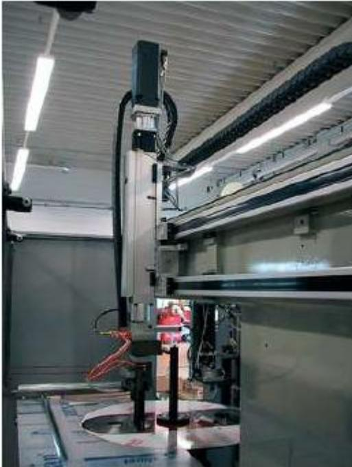
精密直线执行器能够成功应用于物料搬运、机械加工制造等应用领域。丰富的配置选项和配件让大多数应用都能够容易地选择最合适的执行器。
