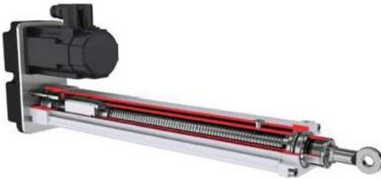
精密直线执行器的设计非常基础。一个电机通过同步带、蜗轮、行星齿轮或直接通过联轴器驱动滚珠丝杆，通过伸缩管将扭矩转换为轴向力。
