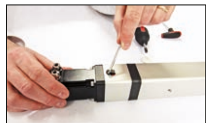
Motorkupplungsschrauben anziehen und Dichtstopfen einsetzen
