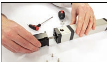
Motorwelle in Kupplung einführen
