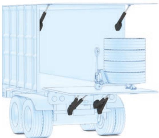
O uso da sincronização para plataformas de elevação móveis em veículos oferece uma solução robusta e confiável, sem a complexidade e os requisitos de manutenção de uma solução hidráulica tradicional.
